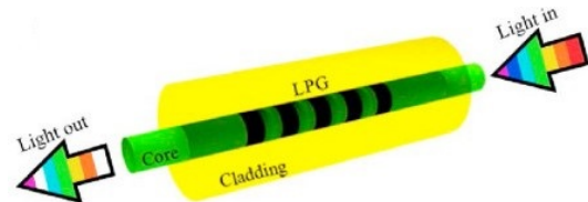
Figura 1: Mecanismo de operação de uma LPG [5].
