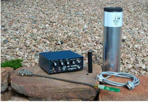
Figure .4: Aparelho Mr.SQUID, composto por: caixa de controlo eletrônica, com 2 baterias de 9V. Probe com um sensor SQUID. Cabos de ligação entre a caixa de controlo e o SQUID. Dewar de azoto líquido.
