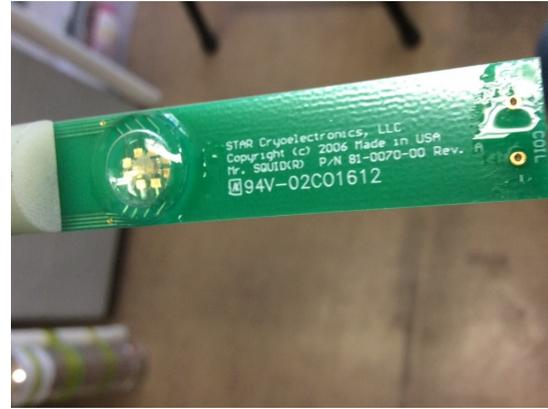
Figure .5: Pormenor da cabeça do sensor do Mr.SQUID. As junções de Josephson não são claramente visíveis, pois tratam-se de dispositivos extremamente pequenos, a camada isoladora deve ser inferior às dezenas de angstroms de espessura[2].
