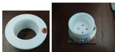
**Figura 2:** *Esquerda: Grelha metálica ; Direita: Contentor dentro do qual é feita a anodização.*
