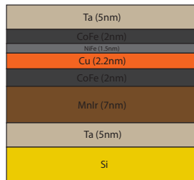
Figura 2.2. Configuração das várias camadas do filme fino que constitui a válvula de spin enunciada.
